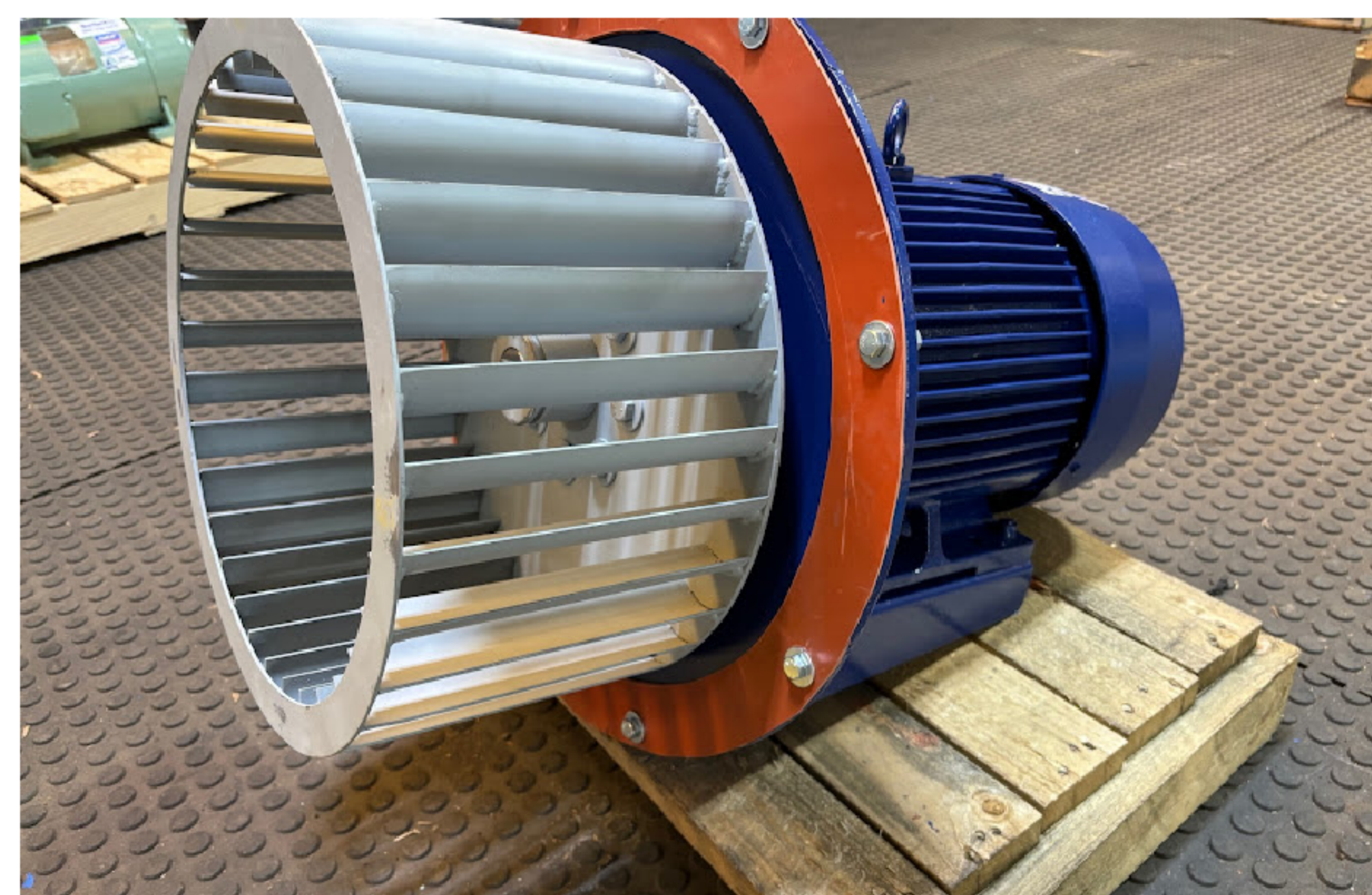
Nuevo ventilador montado en el motor.
